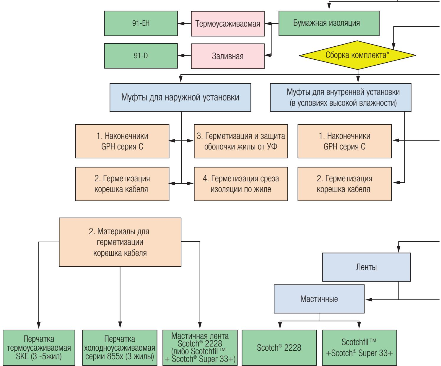
\* - Для бронированных кабелей необходимо дополнительно заказать пружинное кольцо и поводок для подключения к заземлению.
