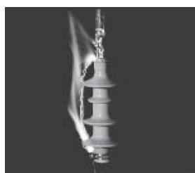
Концевые заделки могут подвергаться воздействию разрядов, таких, как индуцированный грозовой разряд или же разряд вследствие коммутационного процесса в энергосистеме. Правильно разработанная концевая заделка кабеля должна быть стойка к воздействию таких разрядов.
