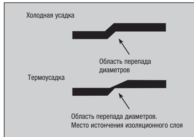
Рис. 1. Изоляционный слой в местах перепада диаметров
