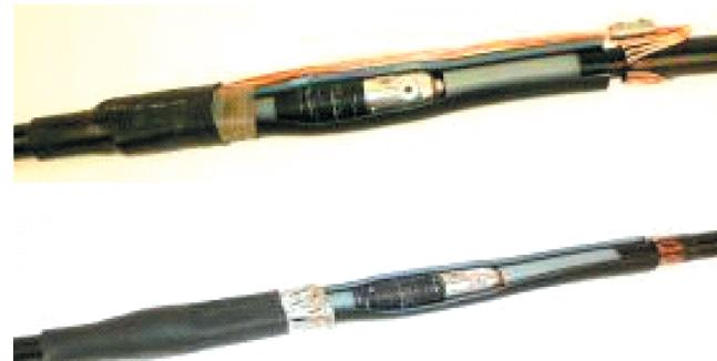
Существует два типа комплектов, в комплекте 92-AS 6x0-1 применяется холодноусаживаемый кожух, а экран кабеля соединяется при помощи медного сетчатого чулка и пружин постоянного давления, а в комплекте 92-AS 2x0-1 применяется термоусаживаемый кожух и экран соединяется путем соединения проволок экрана механическим соединителем.
