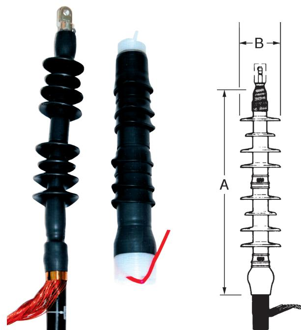
ней в районе среза полупроводящего экрана размещена мастика регулятора поля (3). Спереди муфты размещена герметизирующая мастика (4). Такое строение муфты позволяет избежать двух операций при монтаже – герметизации наконечника и заполнения среза полупроводящего экрана.
