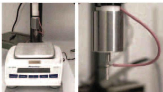
Рис. 3. Испытательная установка для измерения усилия, необходимого для прохождения электрического контакта через покрытие
